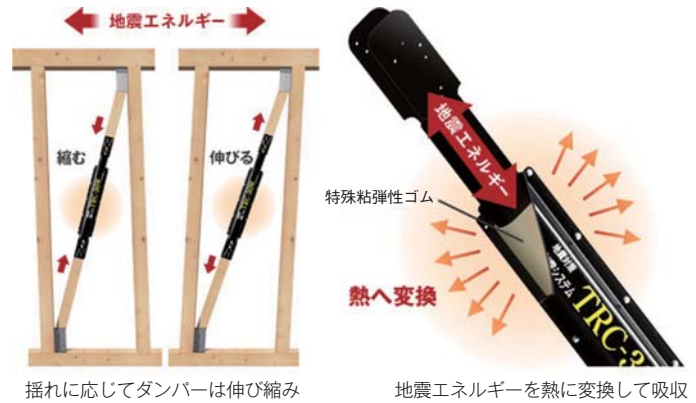
揺れに応じてダンパーは伸び縮み
